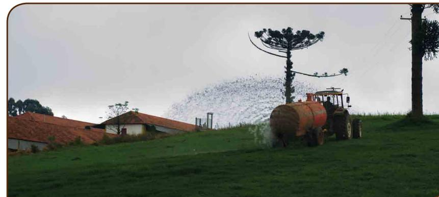
► **Distribuidor mecanizado:** Transporta os dejetos acondicionados em um tanque hermético, que pode estar acoplado a um reboque tratorizado ou ao chassis de um caminhão. Possui um sistema de bombeamento, para aplicação dos dejetos por aspersão sobre o solo ou culturas que se quer fertilizar.
